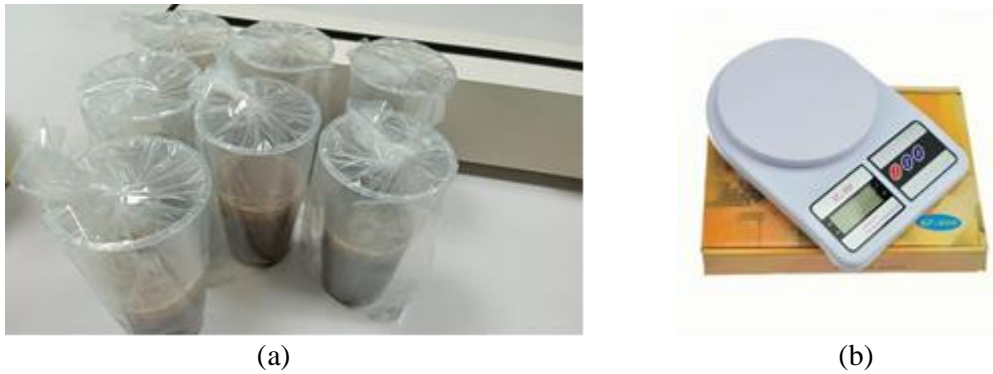
GAMBAR 2. (a) sampel tanah yang telah diambil data, (b) timbangan digital untuk mengukur sampel tanah yang akan digunakan.
