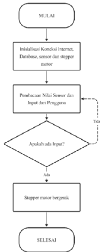
GAMBAR 2. Diagram alur sistem perangkat lunak pada mikrokontroler ESP32
