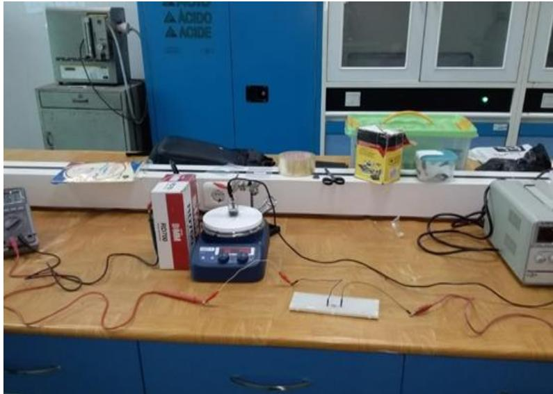
**GAMBAR 1.** Rangkaian alat untuk proses elektrodeposisi
