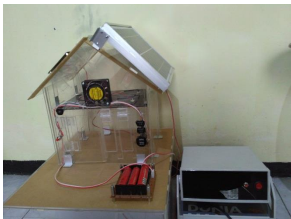
Gambar 2. Alat peraga energi terbarukan hasil penelitian
