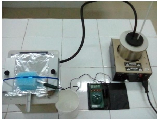
GAMBAR 1. Setup Penelitian menentukan konduktivitas termal pada daun bayam.
