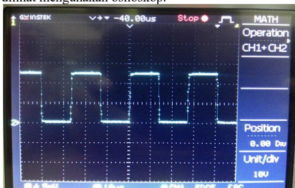
Gambar 3 bentuk gelombang sebelum masuk ke trafo
