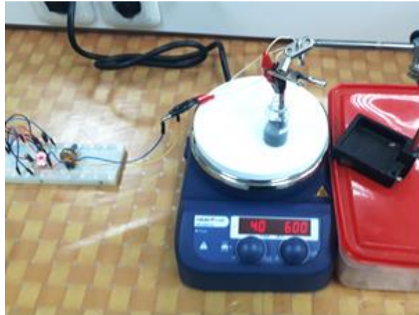
GAMBAR 2. Proses Elektrodeposisi Lapisan Komposit Ni-TiN-AlN/Si 3 N 4 pada Substrat Tungsten Karbida
