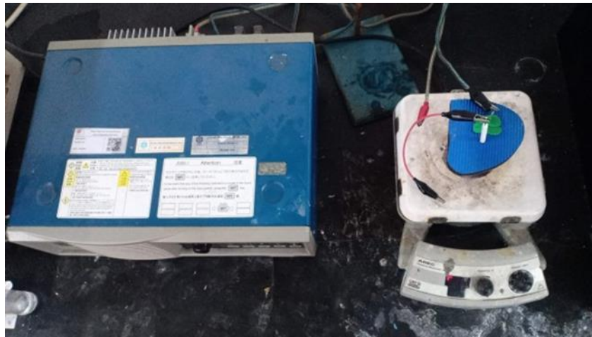
GAMBAR 1. Proses Electrophoretic Deposition (EPD) pada substrat Magnesium AZ31
