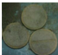
Gambar 2. Pelet hasil pengompakan berdiameter 2 cm, tebal 2mm dan berat 2 gram.
