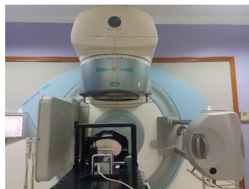
Gambar 3. Verifikasi fantom gerak menggunakan CBCT sebelum dilakukan penyinaran.
