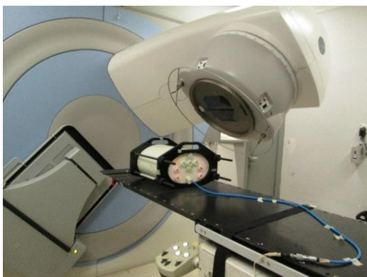
Gambar 3. Pengukuran dosis titik di fantom CIRS 002 LFC pada salah satu uji kasus
