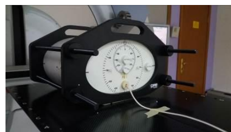
Gambar 2. Pengukuran menggunakan Exradin A16 pada Fantom Homogen
