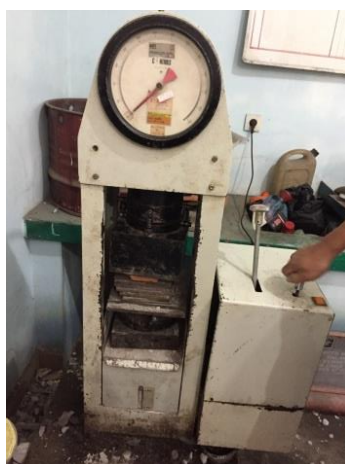
GAMBAR 2. Proses penekanan genteng dengan alat uji tekan 1300 kN
