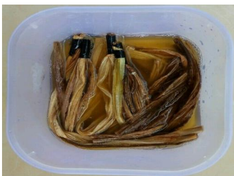
Gambar 1. Perendaman serat pelepah pisang dalam larutan kitosan
