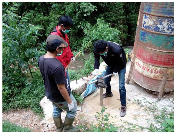
Gambar 2.1. proses coring untuk mengambil sampel sedimen
