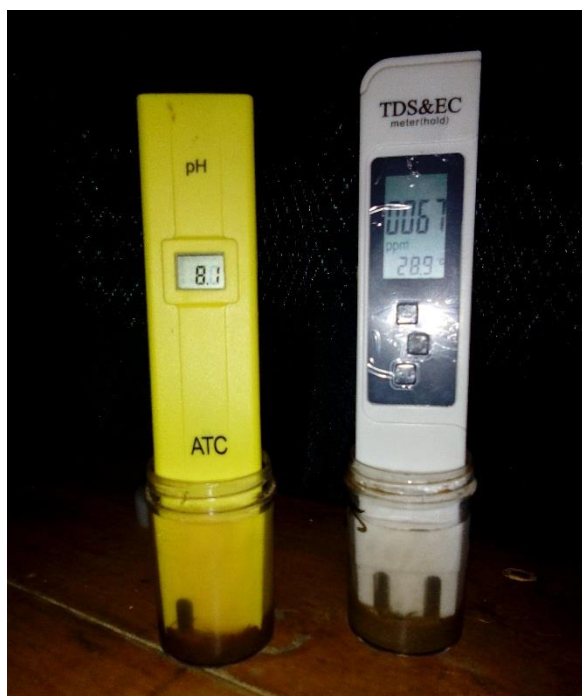
Gambar 2.4. Alat uji pH (kiri) TDS & Electrical Conductivity (kanan)
