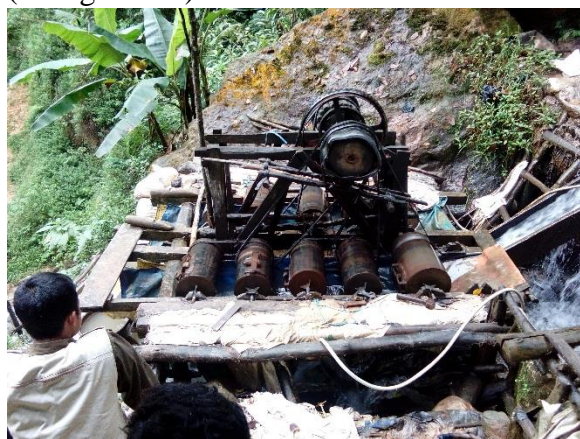
Gambar 1. Gambar alat amalgamator yang digunakan warga untuk mengolah kerikil kuarsa
