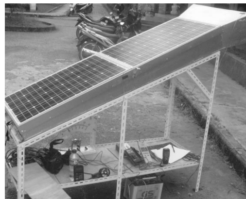
Gambar 3 Skema pengujian modul PV (100 W p )
