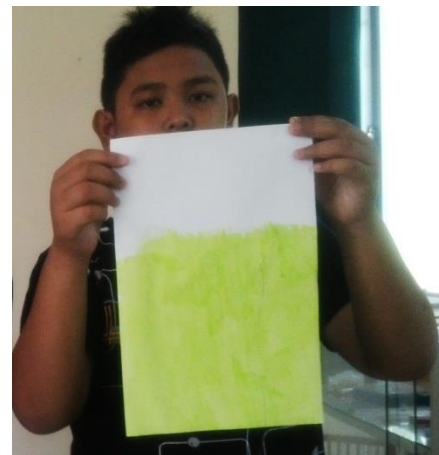
Gambar 3. Kertas HVS yang dilapisi campuran cat tembok dan cangkang telur ayam
