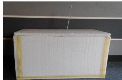
Gambar 5. Pendingin sederhana tampak bagian luar
