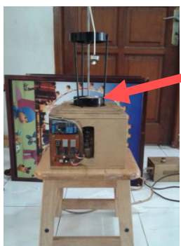
Alat peraga saat validasi (detector menggunakan sensor sentuh)
