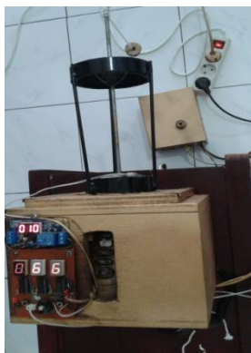
Alat peraga setelah di validasi (perbaikan dan revisi alat setelah uji coba produk lapangan) Revisi menggunakan detektor dengan sensor cahaya
