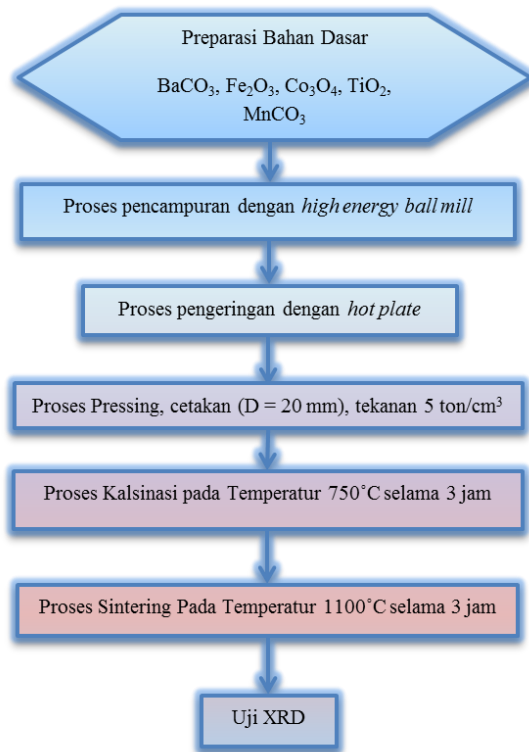
Gambar 1. Diagram alir preparasi dan pengujian sampel Barium heksaferrit dengan substitusi ion Mn, Co dan Ti.
