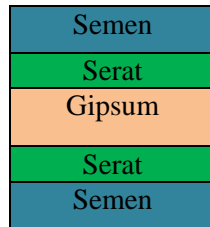
Gambar 1. Susunan lapisan bahan komposit
