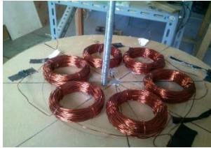
Gambar 2.2 Bagian Stator, Kumparan 3 fasa
