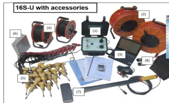
Gambar 6. 1 set lengkap peralatan PASI Seismograph Tipe 16S24U. Berturut-turut: (1) Digitizer, (2) 2 Set Kabel Konektor receiver, (3) Laptop akuisisi dengan program USB Seismograph, (4) 2 set kabel konektor digitizer ke trigger receiver, (5) 24 buah receiver seismograph.komponen vertikal dan 1 buah trigger receiver, (6) Landasan besi, (7) Palu Gada seberat 5 kg dan (8) Aki 12v. (2)
