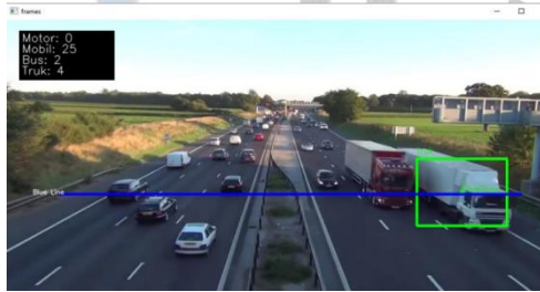
GAMBAR 3. Tampilan saat proses penghitungan jumlah kendaraan yang melewati garis bantu.
