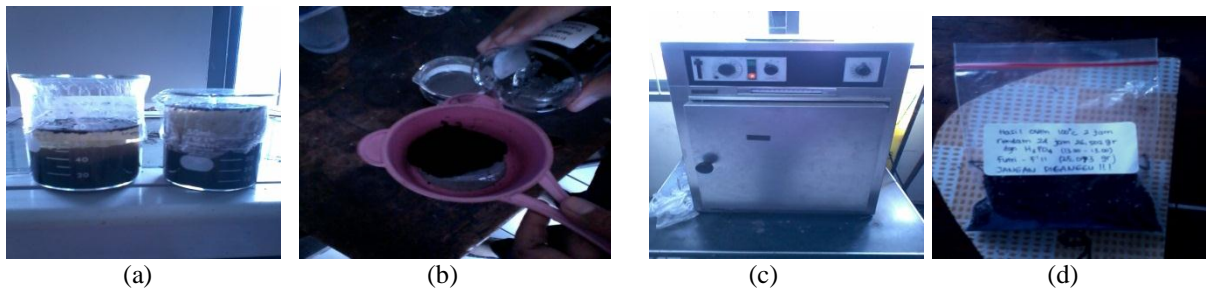
Gambar 2. (a) aktivasi kimia dengan merendam granul arang tempurung kelapa; (b) proses penyaringan arang yang sudah diaktivasi; (c) arang yang sedang dioven; (d) sampel arang hasil aktivasi.
