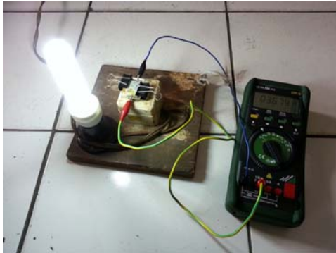
Gambar 2. DSSC berbahan dasar klorofil daun cincau yang menghasilkan tegangan saat terkena cahaya.
