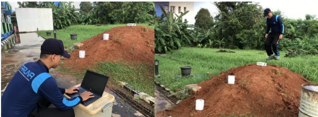
Gambar 3. 3 Simulasi deteksi tanah longsor dengan memberikan trigger
