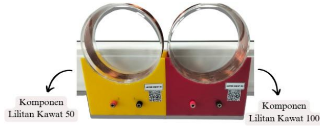
GAMBAR 3. Alat Peraga Medan Magnet Menggunakan Kawat Penghantar
