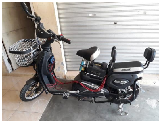
Gambar 2. Sepeda Listrik Dengan Baterai Lithium-Ion 18650
