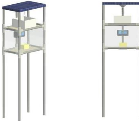
Gambar 3. Desain alat lampu pembasmi hama
