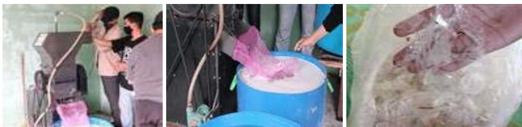
Gambar 6. Proses pengolahan sampah botol plastik menggunakan mesin pencacah botol plastik.
