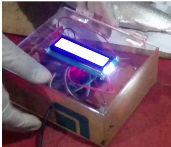
Gambar 5. Hasil Rancang Bangun Detektor Kesegaran Ikan
