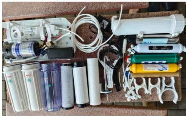
Gambar 2. Komponen-komponen Mesin RO 500 GDP 8 Stage
