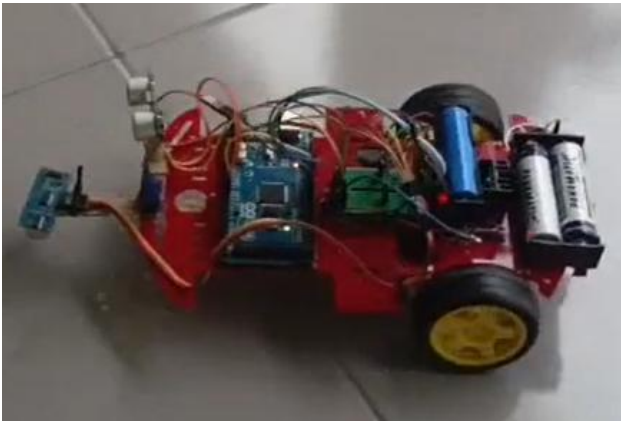
Gambar 4. Detail Pemasangan Baterai Robot (Dokumen Pribadi)
