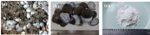
Gambar 1. (a). Limbah cangkang kerang loker, (b). Cangkang kerang loker mentah, (c). Abu cangkang kerang loker setelah kalsinasi (Sumber: Peneliti, 2025)
