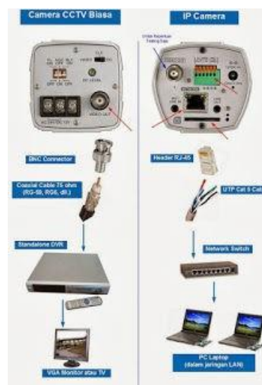
Gambar 2. Perbandingan blok diagram CCTV dan IP camera
