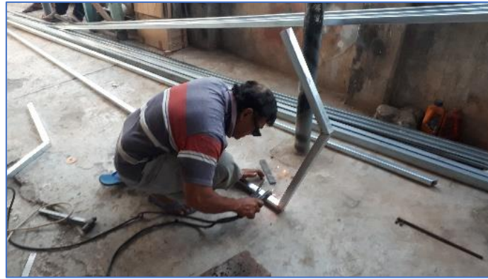
Gambar 5. Pengelasan Tiang Lampu
