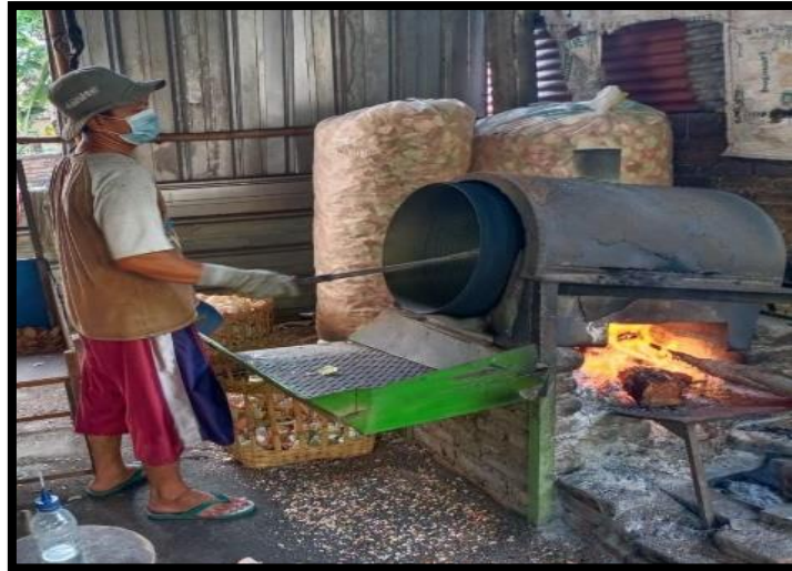
Gambar 3. Proses produksi Mesin penggorengan awal manual dan bahan bakar Kayu
