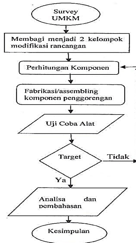
Gambar 4. Flow chart Perancangan mesin penggorengan krupuk pasir
