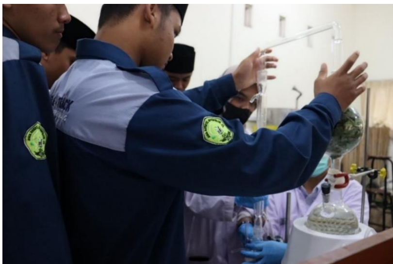
Gambar 4. Demo cara penyulingan daun sereh wangi untuk mendapatkan minyak sereh wangi skala laboratorium
