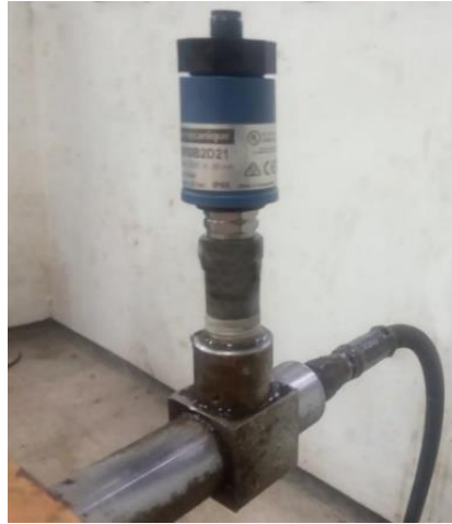
Gambar 8 Sensor Pressure Transmitter yang terhubung ke alat CTM ( Compression Testing Machines )
