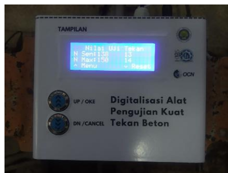
Gambar 18 Rangkaian digital pembaca hasil pengujian bahan Compression Testing Machines (CTM)
