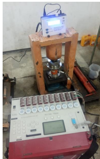
Gambar 16 Proses pengujian bahan uji untuk kalibrasi turunan Compression Testing Machines (CTM) dengan Load Cell dan Data logger
