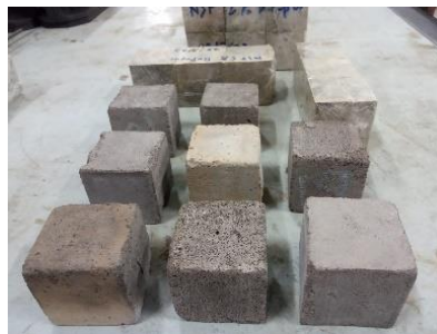
Gambar 13 Bahan uji untuk kalibrasi turunan mesin Compression Testing Machines (CTM) dan Universal Testing machine (UTM)
