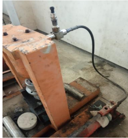
Gambar 10 Sensor Pressure Transmitter 100 Bar yang terhubung ke alat CTM ( Compression Testing Machines )
