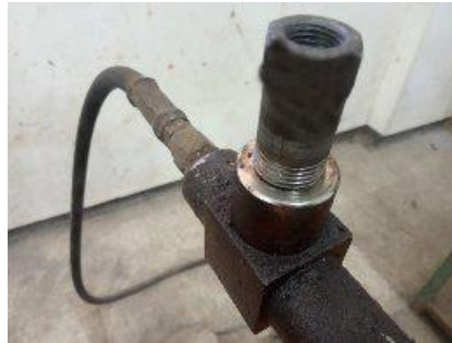
Gambar 6 Interface penghubung yang menempel Pipa Drat CTM ( Compression Testing Machines )
