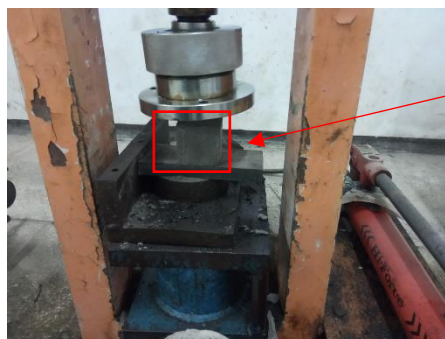
Gambar 14 Proses pengujian bahan uji untuk kalibrasi turunan Pada mesin Compression Testing Machines (CTM)
