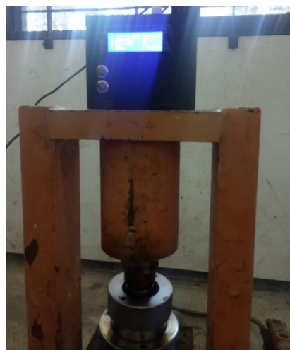
Gambar 12 Sensor Pressure Transmitter 100 Bar yang terhubung ke alat CTM ( Compression Testing Machines )
