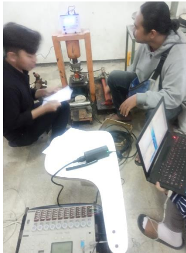
Gambar 17 Proses pengujian bahan uji untuk kalibrasi turunan Compression Testing Machines (CTM) dengan Load Cell dan Data logger
