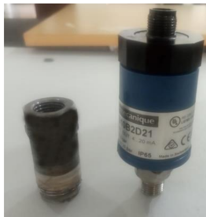
Gambar 7 Interface penghubung dan Sensor Pressure Transmitter
