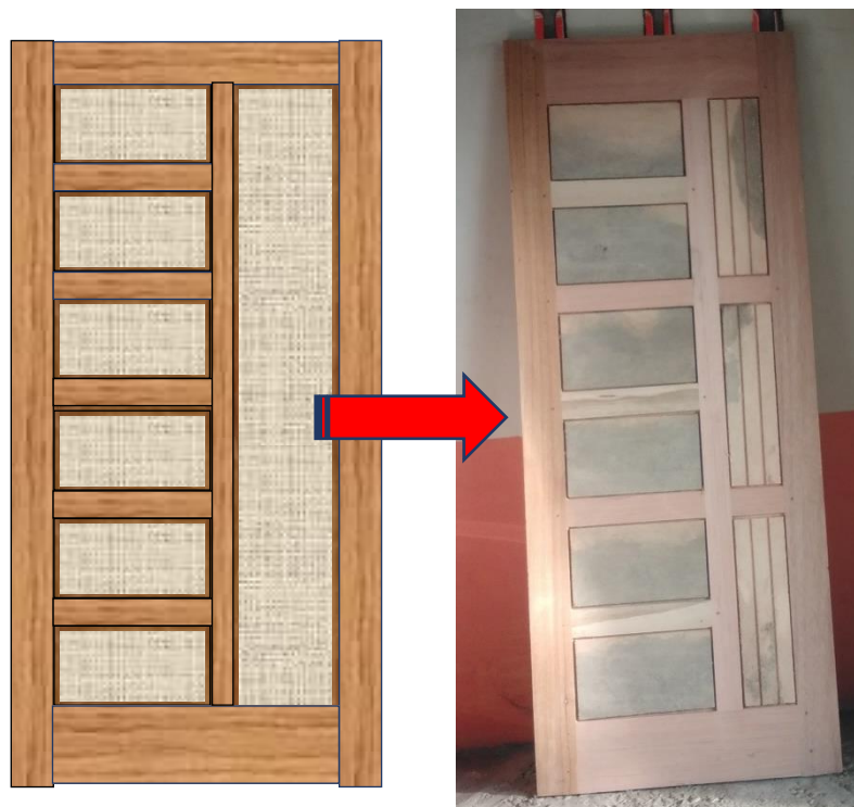
Gambar 3. Model Disain Panel Pintu (kiri) serta Hasil Uji Coba Penerapan Panel Pintu dari Bahan Papan Sawit (kanan)
