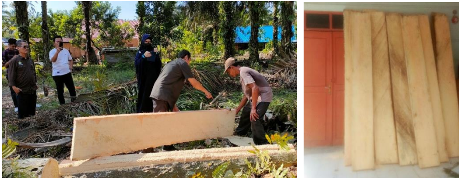
Gambar 1. Pengolahan Batang Sawit menjadi Papan: Tahap Pengolahan Awal dan Pengawetan (kiri) dan Tahap Pengeringan Papan Sawit (kanan)
