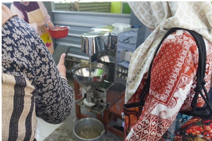
Gambar 5. Mencetak bakso ikan menggunakan mesin cetak bakso
