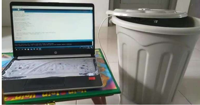
Gambar 5. Tong Kompos dengan tutup telah terpasang Mikrokontroler (MCU) ESP32
