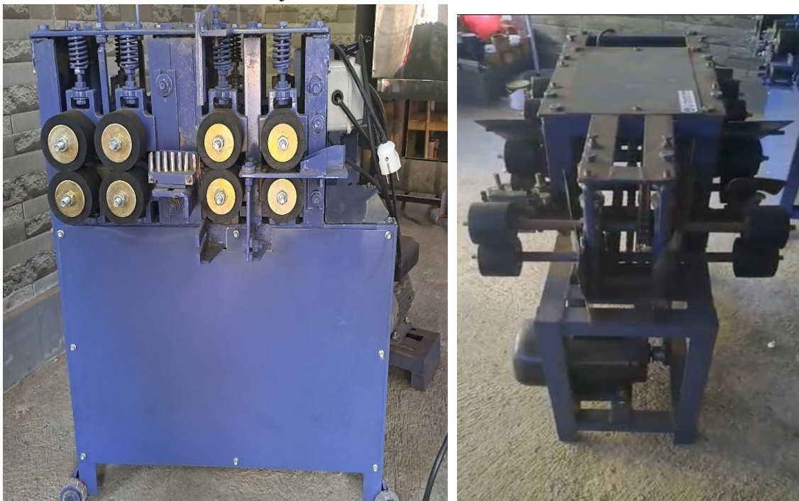
Gambar 2. Teknologi Tepat Guna (TTG) Mesin Irat Bambu 0,5 Hp
