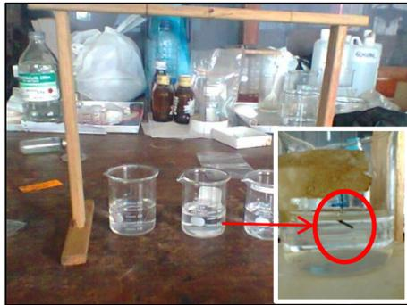
**Gambar 1.** Pengujian korosi lapisan komposit Ni-TiAlN pada larutan asam NaCl 35%.
