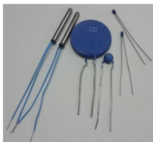
GAMBAR 1. Sensor suhu PTC yang diproduksi EPCOS
